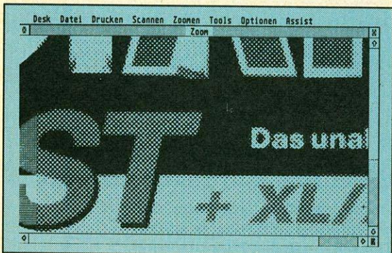
Durch Amplitudenmodulation kann bei Marvin aus dem geometrischen ein Zeitungsrastrer errechnet werden
